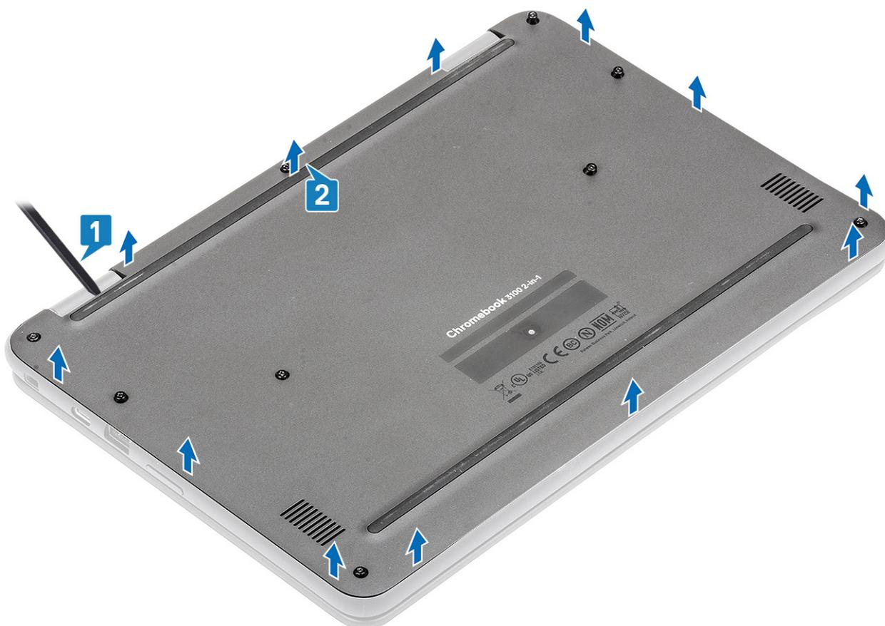
**REMARQUE :** Lorsqu'ils retirent le capot de la base, les techniciens sur site doivent agir avec précaution. Des renforcements de dégagement sont accessibles à côté des charnières gauche et droite afin de faciliter la procédure de démontage. Avec une pointe en plastique, faites levier sur la partie supérieure gauche du cache de fond, puis continuez sur les côtés gauche et droit du cache de fond, et retirez-le complètement du système.
