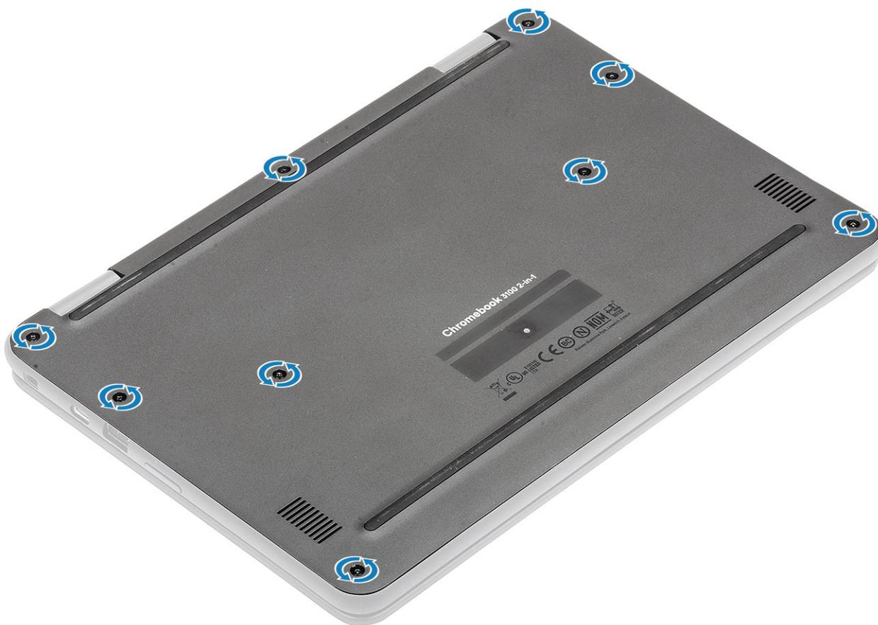
2. Faites levier sur le capot de la base à l'aide d'une pointe en plastique [1, 2].
